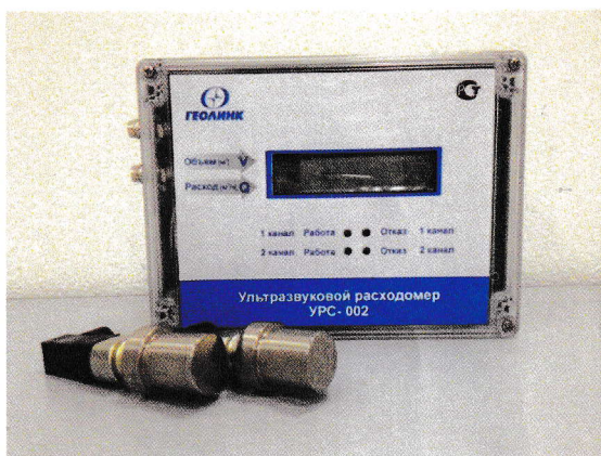
Рисунок 1 – Комплект расходомера без измерительного участка.
